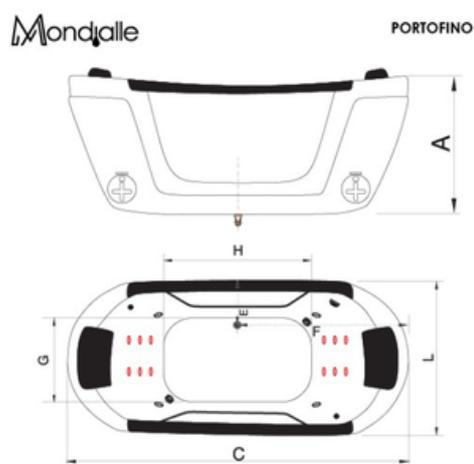
Obs. Para a instalação dos rolletes e demais equipamentos eletro-eletrônicos, deve-se deixar um espaço de 1m, ao redor de toda a banheira.
