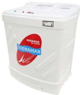
Os geradores de vapor Compact Line Tradicional e Inox Sodramar são constituídos de materiais anti-corrosivos, com gabinete confeccionado em termoplástico e resistência (s) blindadas com potências que variam de 6kW a 27kW para ambientes que vão de 3m<sup>3</sup> a 50m<sup>3</sup>, podendo ser alimentada em 220V ou 380V. Os modelos Tradicionais possuem reservatório interno em chapas de aço galvanizado ou aço inox.
